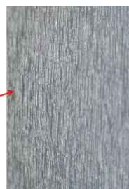
Ein eloxiertes Blech wurde umgeformt und zeigt im Bereich der stärksten Umformung Risse
